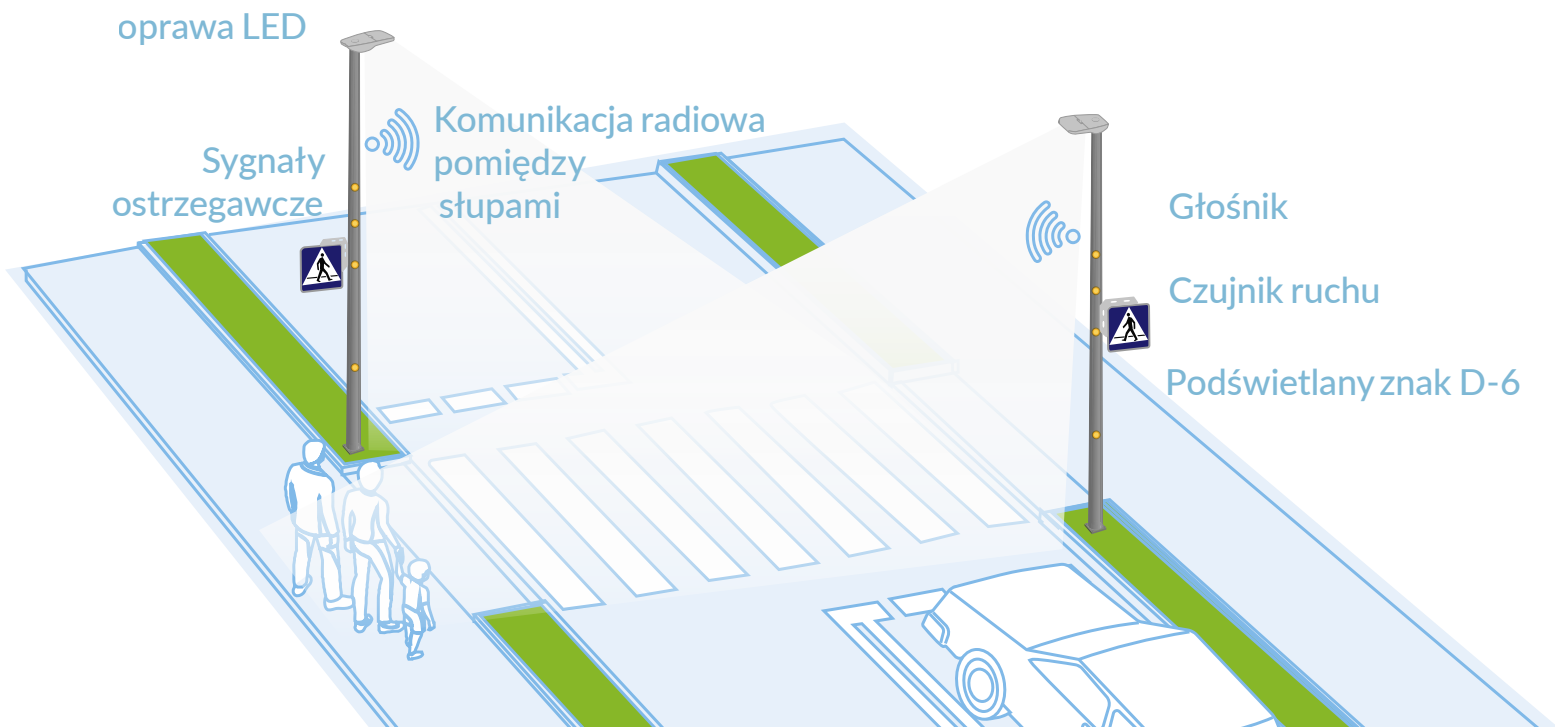
Zaawansowane przejście dla pieszych zapewniające najwyższy poziom bezpieczeństwa pieszemu.
